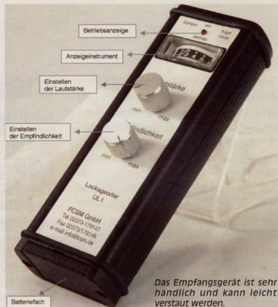
Das Empfangsgerät ist sehr handlich und kann leicht verstaut werden.
