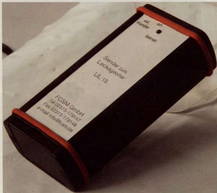
Der Sender wird außen oder innen vor dem Bauteil positioniert. Alternativ steht auch eine kleinere Version zur Verfügung, die mit Hilfsmitteln platziert werden kann.
